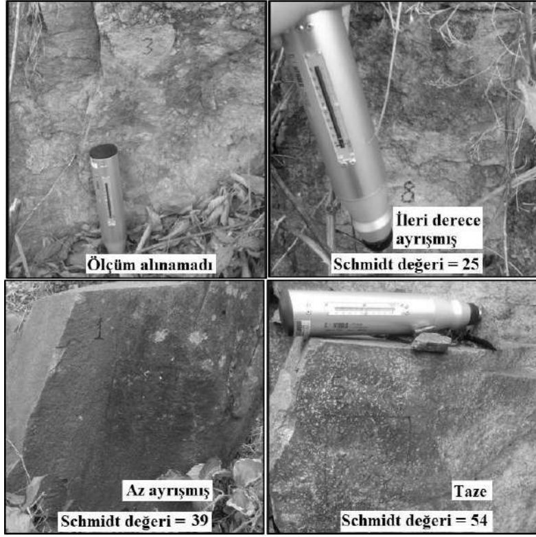
Şekil 2. Farklı bozunma/ayırışma derecelerinin Schmidt değerine etkisi
